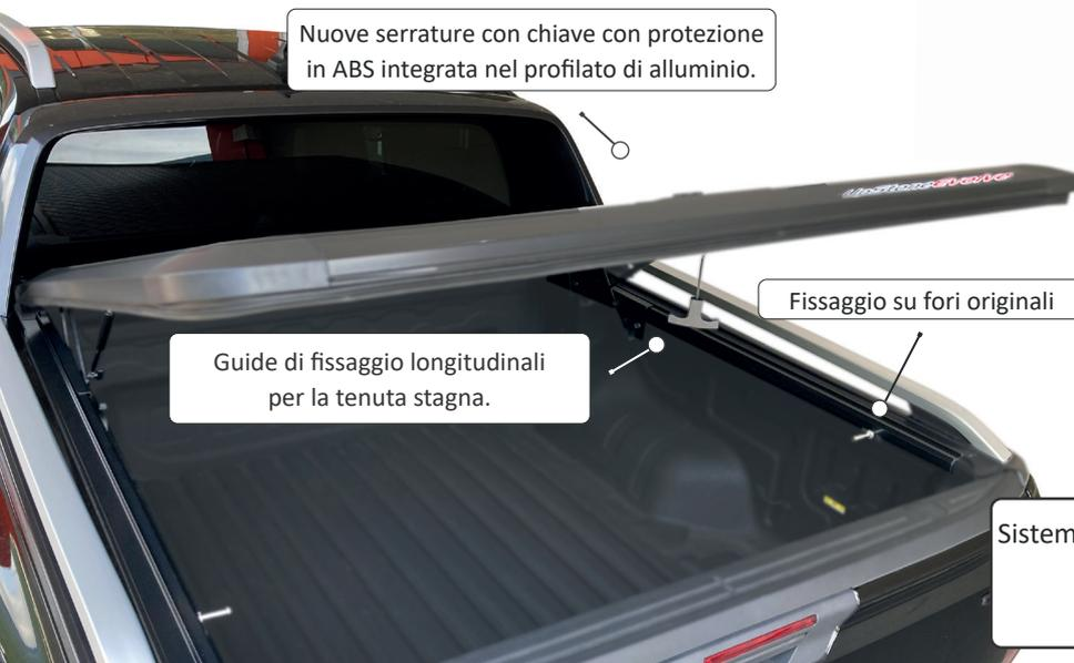
Nuove serrature con chiave con protezione in ABS integrata nel profilato di alluminio.
