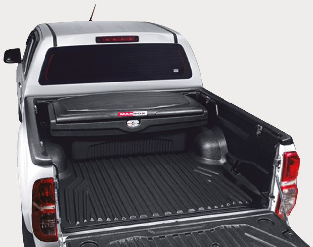
BOITE A OUTILS ABS Noir Fermeture à clé 1320 X 505 H : 475 mm
