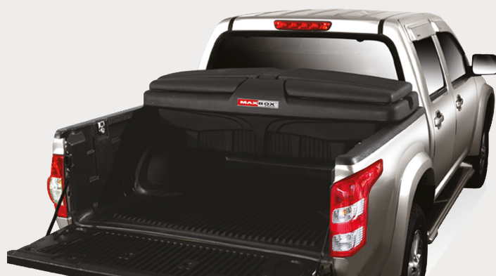
BOITE A OUTILS ABS Noir 263 L Double ouverture papillon Fermeture à clé 1580 X 650 H : 466 mm
