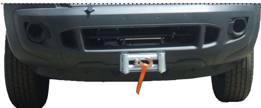
MONTAGE AVEC TREUIL À CABLE : C-0083/9
