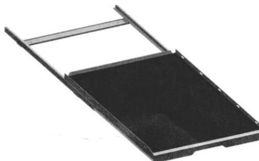
Si le traîneau de chargement doit avoir des accessoires installés sur le châssis de roulement, il est préférable pour l'accès, que ces derniers soient installés sur le châssis avant que le châssis soit boulonné au véhicule.
